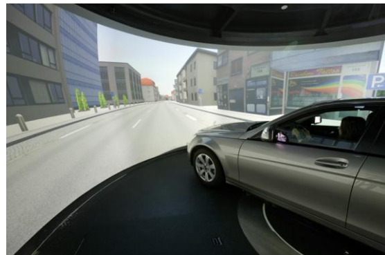
Abbildung: Blick in den Daimler-Fahr Simulator [Quelle: Barco]
